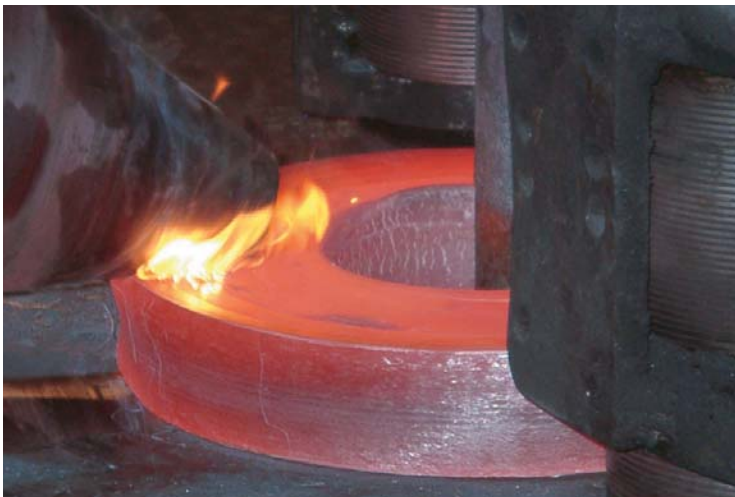
Forgeage de la matrice d'emboutissage en ALBROMET 380 sur le moulin à cylindres annulaires
